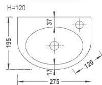
Lave-main ultra-petit, de forme semi-arrondie. Effet „source“, grâce à la profondeur de 85 mm. La version résine (Semi 28 MC), aux contours très aigus, et variante du trou robinet gauche (.B).
