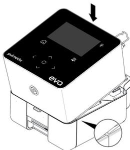
5. Schließen Sie das Netzkabel am Gerät an. Sichern Sie das Netzkabel mit Hilfe des Sicherungsbügels am Gerät. Das andere Ende des Netzkabels stecken Sie in eine spannungsführende Steckdose.
