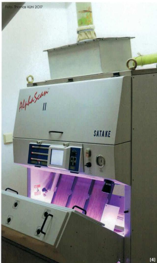
[4] Der Farbausleser analysiert das Getreide mithilfe von Kameras. Durch kurze Druckluftstöße werden beim Roggen dunkles Mutterkorn und beim Weizen zum Beispiel dunkle Wickensamen aussortiert. [5] Die Rohstoffe für das Mehl beziehen die Oderland Mühlenwerke größtenteils von Lieferanten aus der Region. Die Mühle untersucht das Getreide dann im Mahlprozess unter anderem auf Feuchte, Protein- und Mineralstoffgehalt. [6] Der Fuhrpark des Unternehmens besteht aus zehn LKWs.
