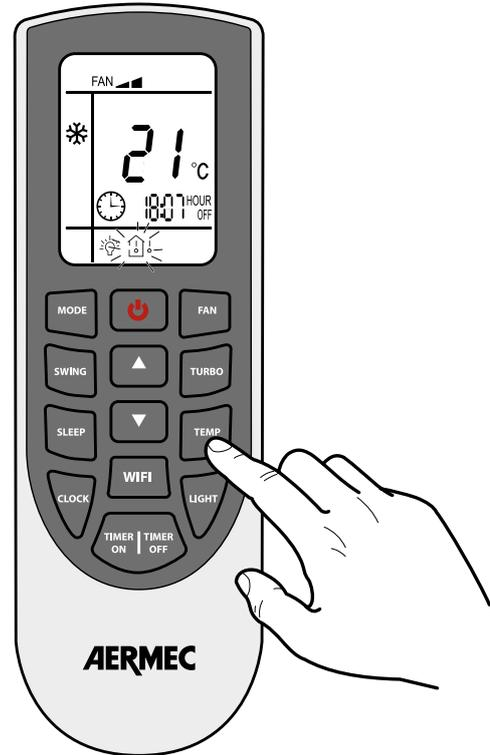
Wenn die Einheit eingeschaltet ist und die Anzeigen am Display der Inneneinheit freigegeben sind, können mit jedem Drücken der Taste
