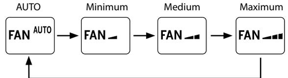
■ **HINWEIS:** Neben den drei Geschwindigkeiten (AUTO ist ein Steuerungselement, welches die beste Geschwindigkeit auf Basis der Umgebungstemperatur auswählt) existiert eine weitere Funktion namens TURBO (wird später erklärt), für welche eine weitere Geschwindigkeit besteht, die über der Maximalgeschwindigkeit liegt.
