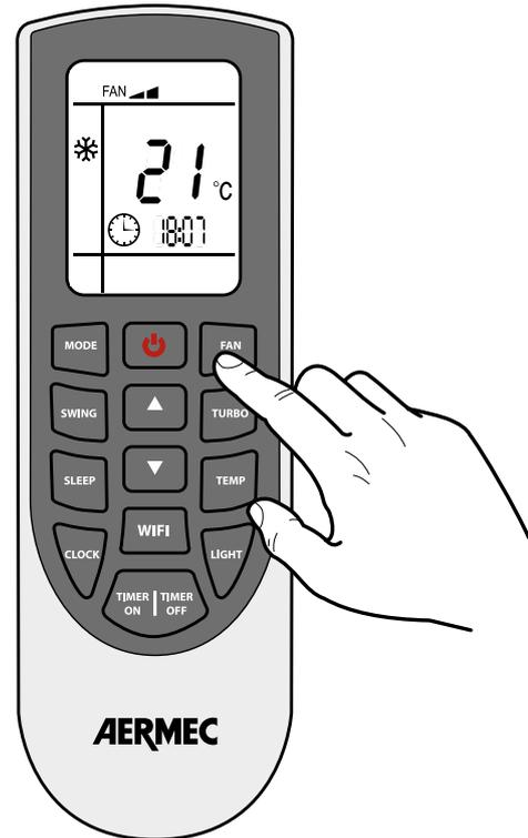
Wenn das Gerät eingeschaltet ist (und weder der Automatikbetrieb noch die Entfeuchtung gewählt wurde), kann durch Drücken der Taste
