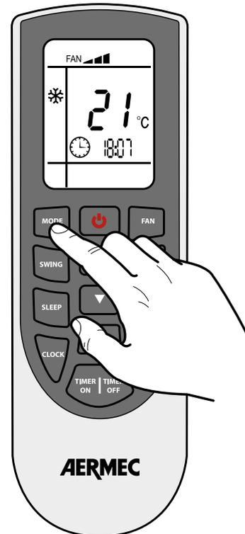
Wenn das Gerät eingeschaltet ist, durch Drücken
