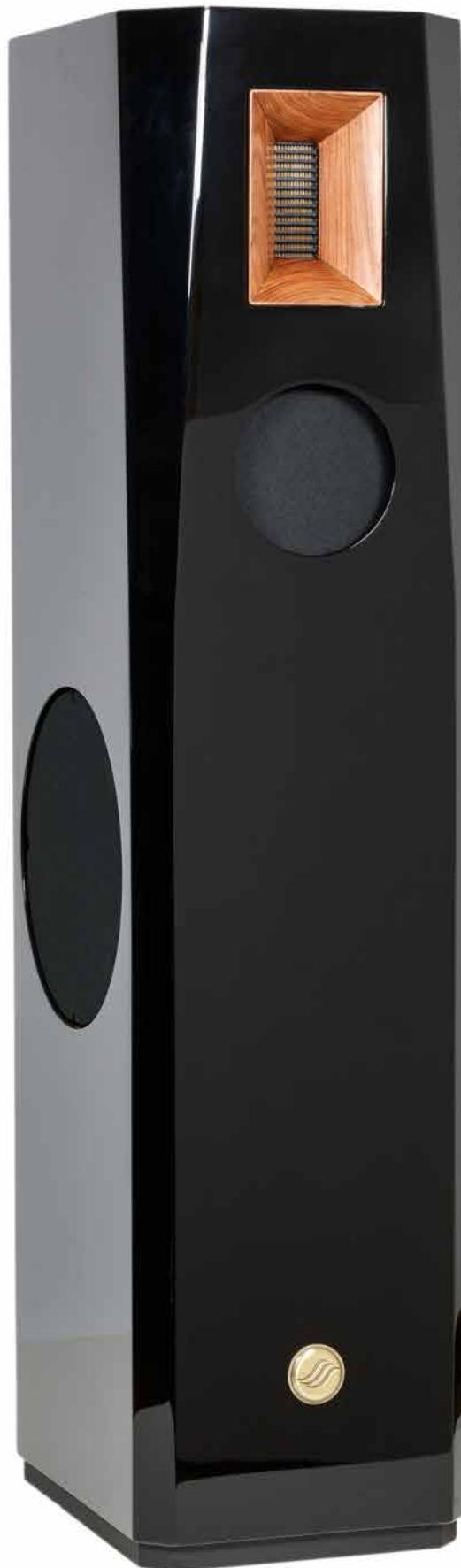
Die wohldimensionierte Robin ist teilaktiv ausgelegt. Mittel- und Hochtönen arbeiten passiv, die beiden seitlich verbauten Bässe werden von Class-D-Kraftwerken angetrieben. 2 x 500 Watt geben den Basstreibern (Foto links) gehörigen Schub und verleihen dem Rotkehlchen ein autoritäres Fundament.
