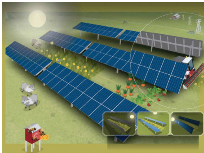
Bei dem Solverde-System mit einachsigen Trackern können die Modultische zum Ernten und Pflügen senkrecht gestellt werden (rechts).
