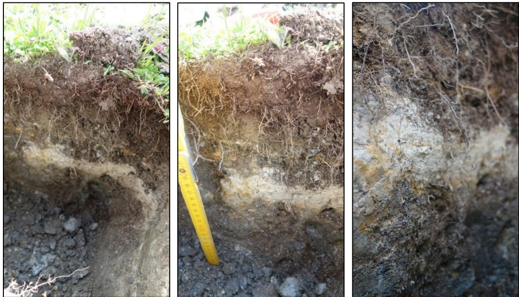
Abbildung 14: typischer Bodenaufbau im Seebecken, mit stauendem Untergrund, Seekreide, Oberboden, sowie Rostfleckung (Profil Nr. 5)
