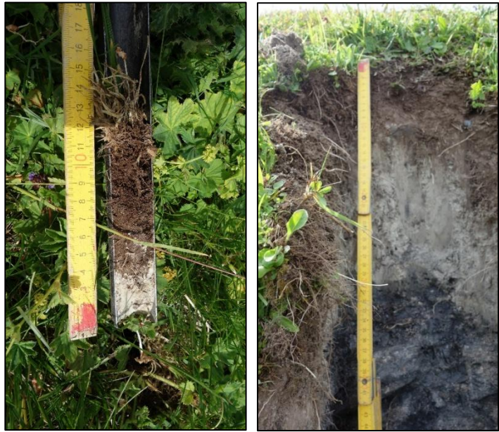
Abbildung 13: typischer Bodenaufbau im Seebecken, im Uferbereich – 6 cm Oberboden über Seekreide (Profil Nr. 3)
