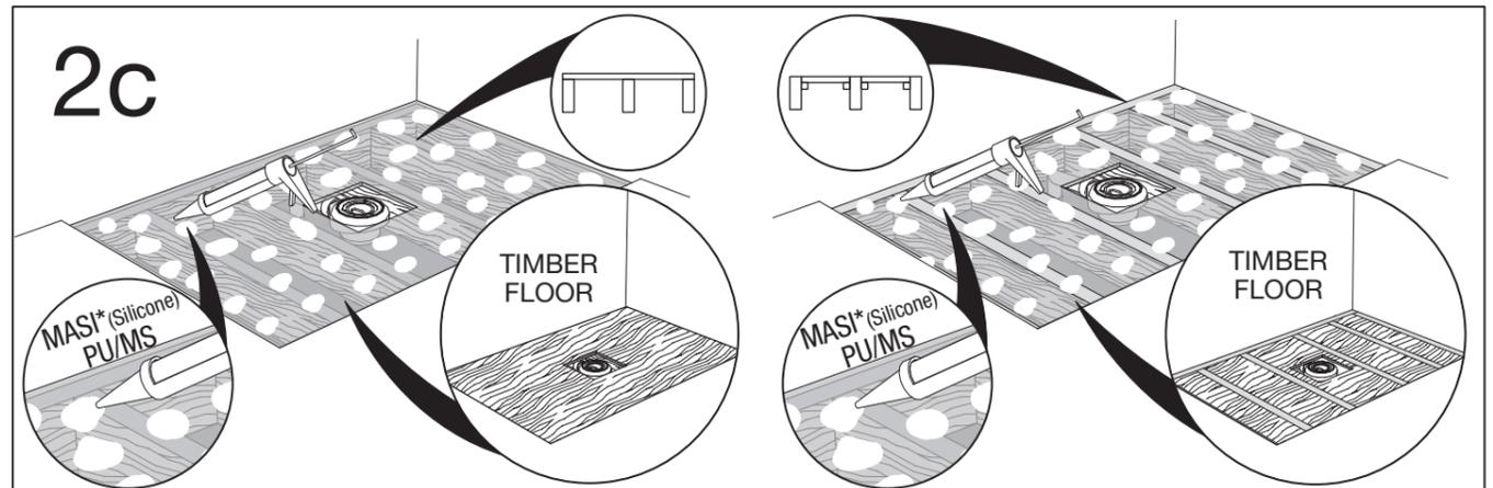
ES La superficie sobre la que se instale el plato debe ser firme y estable (no debe flexionar y/o hundirse), reforzando especialmente zonas críticas, como por ejemplo cortes de columnas.
