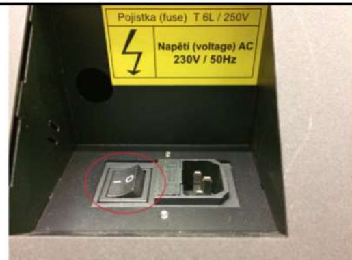
Abbildung 1: Netzschalter an der Geräterückseite
