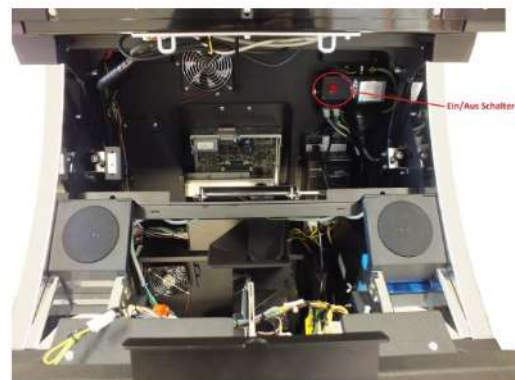
Abbildung 2: Netzschalter am Netzfilter
