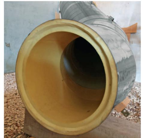
**PU-Hartschaumrohre** mit 800 mm Durchmesser haben eine GFK-Beschichtung.
