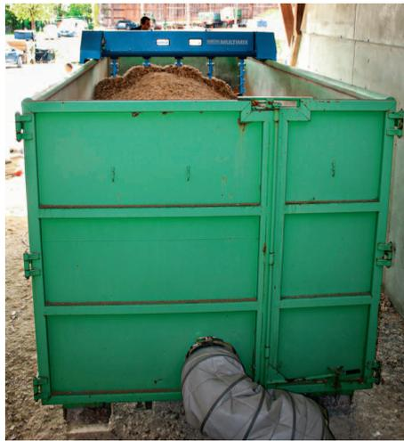
Über einen Bypass kann die Anlage heiße Luft in Container mit Hackschnitzel leiten.
