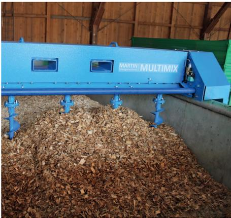
Die fünf Schnecken durchmischen das Trocknungsgut von unten nach oben (ähnliches Prinzip wie beim Futtermischwagen) und sorgen so für eine gleichmäßige und schonende Trocknung.
