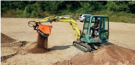
Der Terra-Star® eignet sich für die Bearbeitung von verschiedenen Materialien. Mutterböden absieben, Verfüllmaterialien absieben, bolliges Material zerkleinern, Kalk untermischen zur Bodenverbesserung: alles kein Problem für den Terra-Star®.
