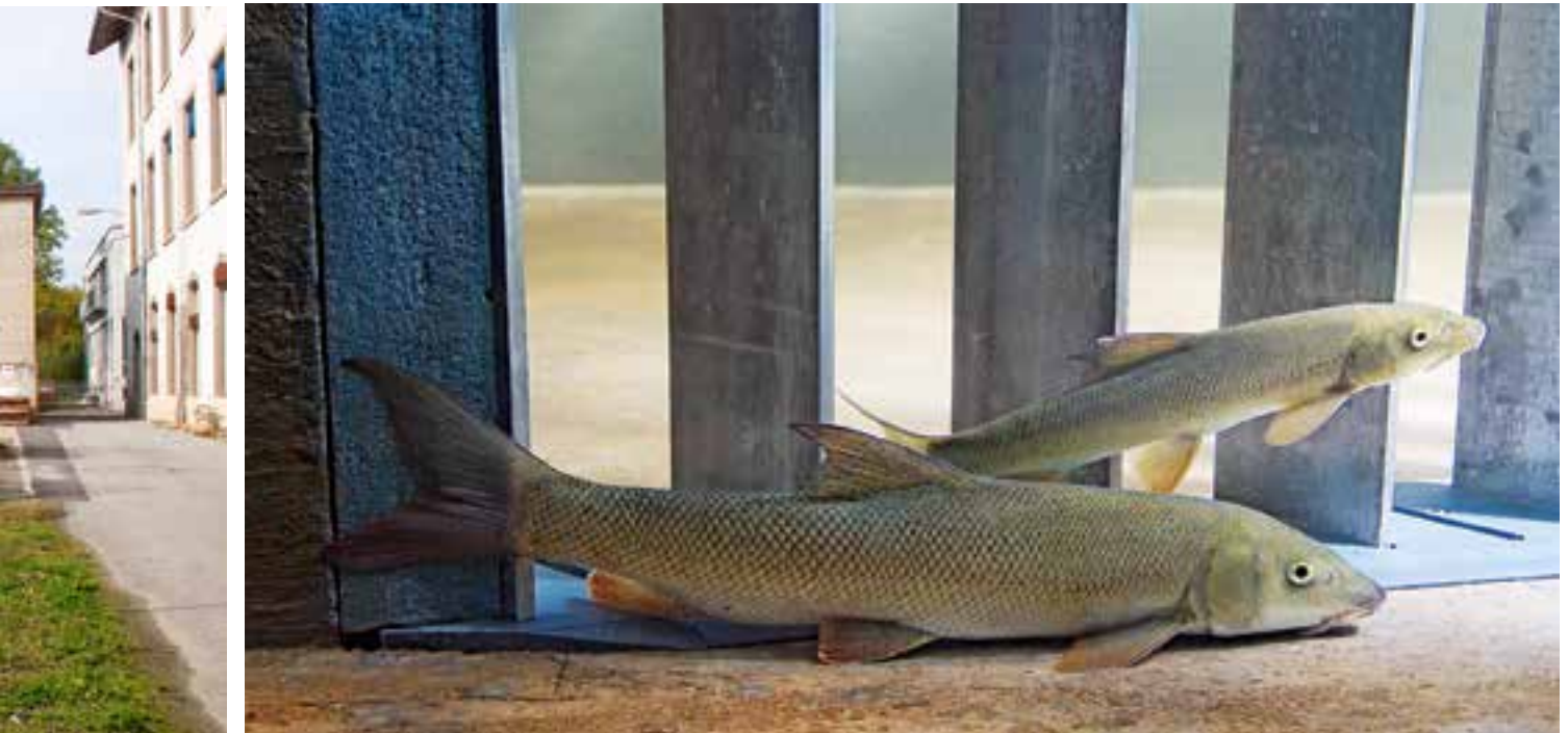
Im Rahmen eines Modellversuchs mit lebenden Fischen – wie diesem Barbenpaar – erforscht die ETH Lösungen für den Fischabstieg bei Wasserkraftanlagen.
