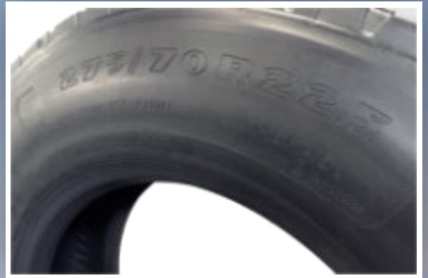
Kalterneuerung mit der Optik einer Heißeerneuerung und verstärkter Seitenwand mit Verschleißindikatoren
