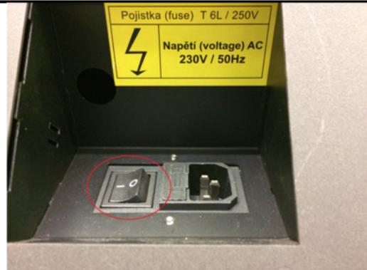
**Abbildung 1: Netzschalter an der Geräterückseite**
