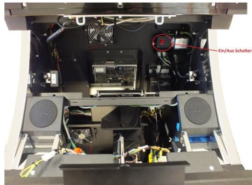
**Abbildung 2: Netzschalter am Netzfilter**
