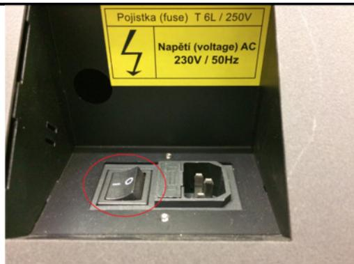
Abbildung 1: Netzschalter an der Geräterückseite
