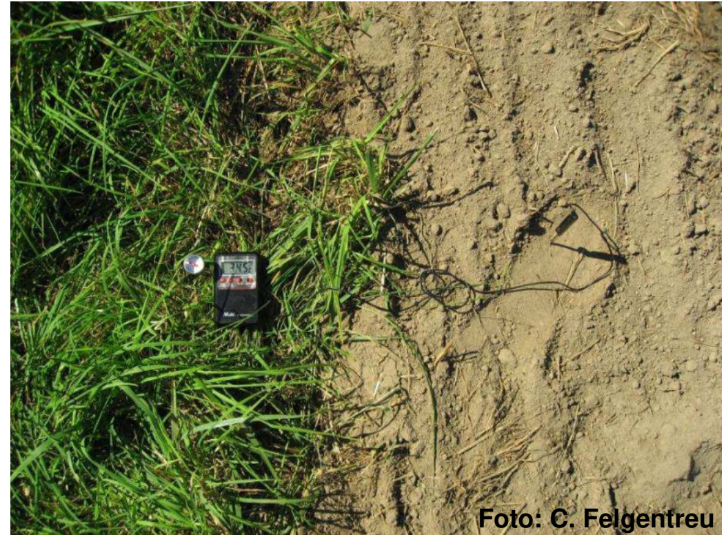
Vergleich der Bodentemperatur am 26.08.16 bewachsener vs. unbewachsener Boden
