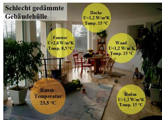
Abb. 8 Oberflächentemperaturen bei einer schlecht gedämmten Gebäudehülle
