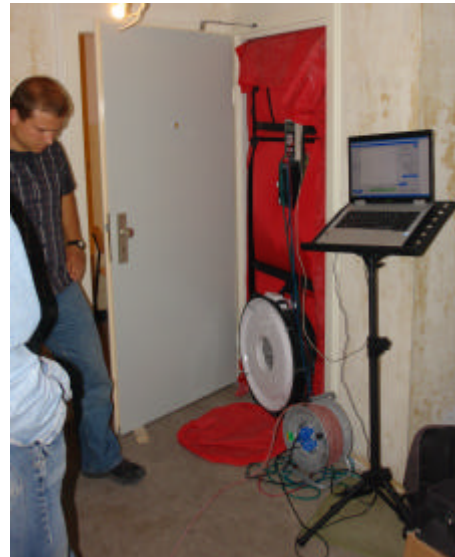
Abb. 3 Blower-Door-Messung in einer Wohnung
