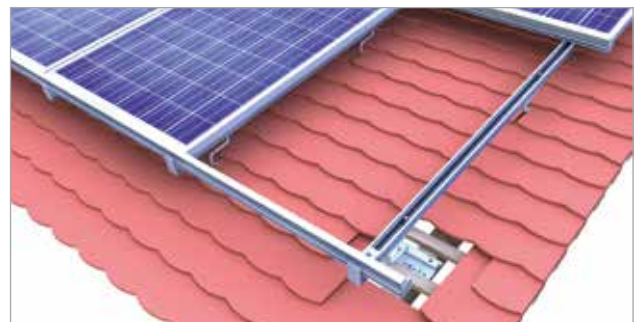
Einlegesystem: Hochkantmontage auf Biberschwanz
