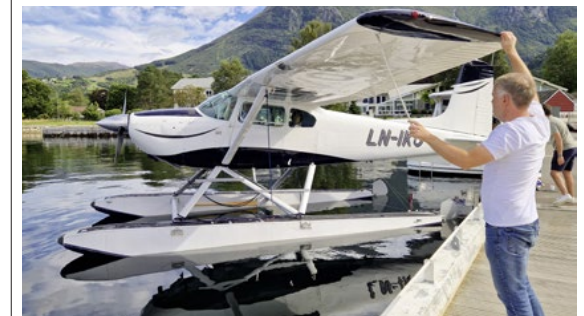
Hilfreich Das Seil am Flächenende stört im Flug nicht wirklich, erleichtert aber am Steg das Manövrieren. Lläuft der Motor einmal, ist Bremsen im Wasser nicht mehr möglich
