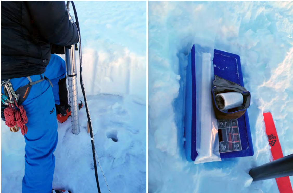
Abbildung 13: Entnahme der Oberflächeneisproben mittels elektrischem Bohrer am 24.11.2021 (Fotos: G. Bertolotti).
