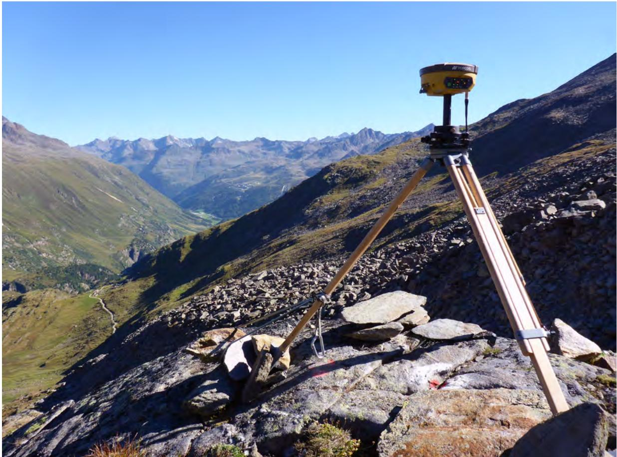
Abbildung 4: DGPS Basisstation bei Punkt 1A am Blockgletscher im äußeren Hochebenkar. Foto: A. Fischer 26.08.2016
