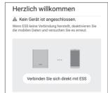
Auf dem Mobilgerät die App 'LG EnerVu Plus' ausführen. Wird die Verbindung zum System erstmals hergestellt, wird der Bildschirm zur Auswahl der Verbinungsmethode angezeigt.
