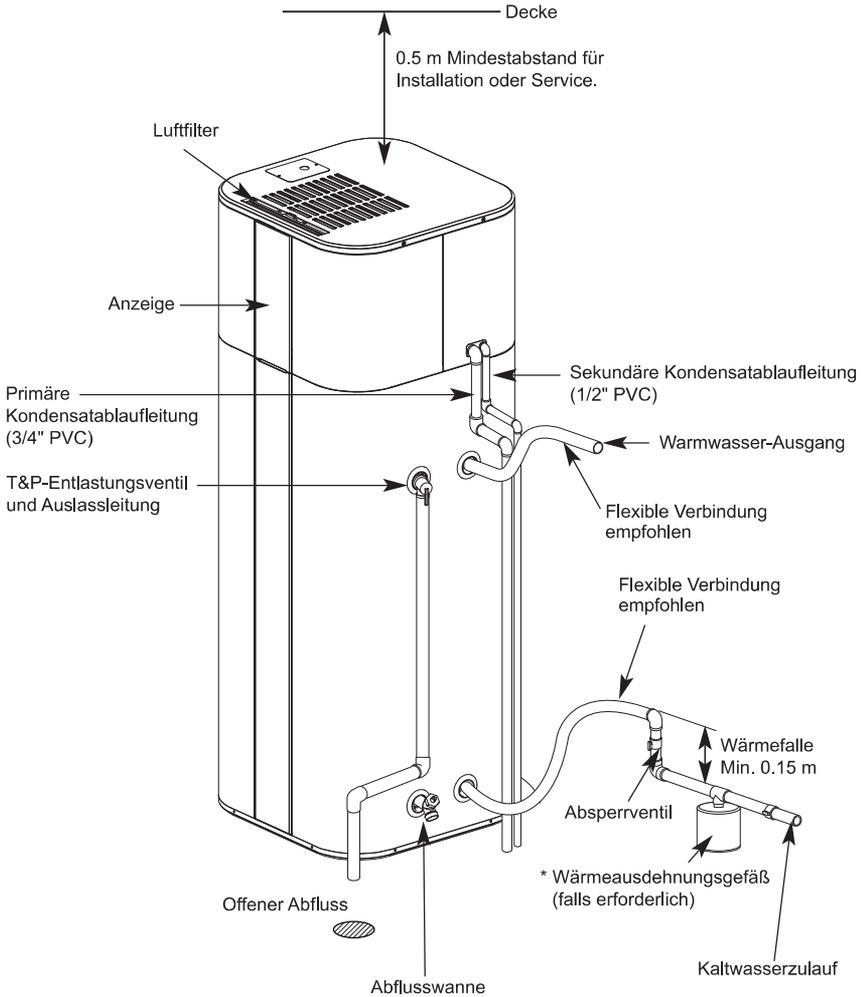
\* Schließen Sie in einem geschlossenen System ein Wärmeausdehnungsgefäß an die Kaltwasserversorgungsleitung an. Siehe Abschnitt "Thermische Ausdehnung" (S.16).
